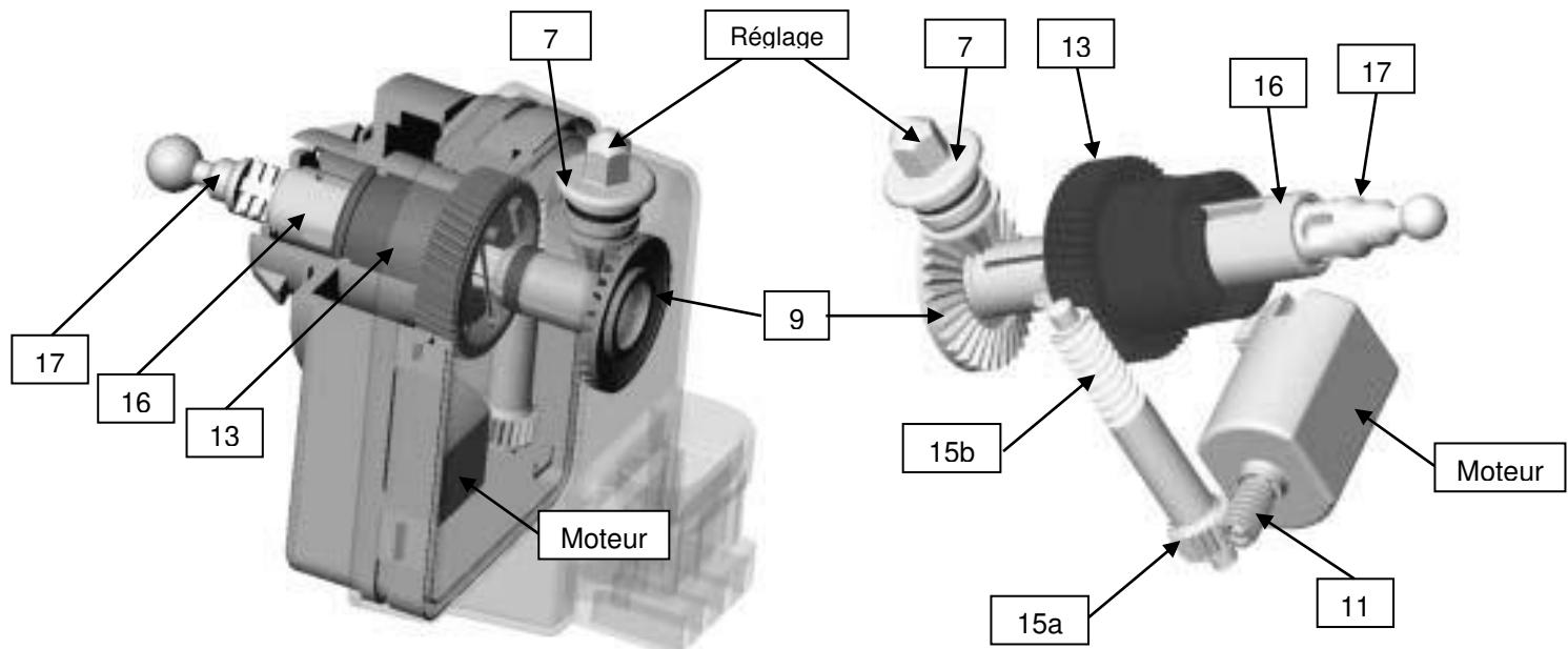
**Réglage manuel** : l'opérateur manipule la tête hexagonale du pignon de réglage **7** qui entraîne en rotation la roue dentée **9**. Le sous-système vis-écrou (**17-16**) permet de transformer la rotation de la roue **9** en une translation de la tige **17**. La sortie de la tige **17** (libre de **16** en mode manuel) permet l'orientation du phare par l'intermédiaire de la biellette de poussée rattachée à la tige.
