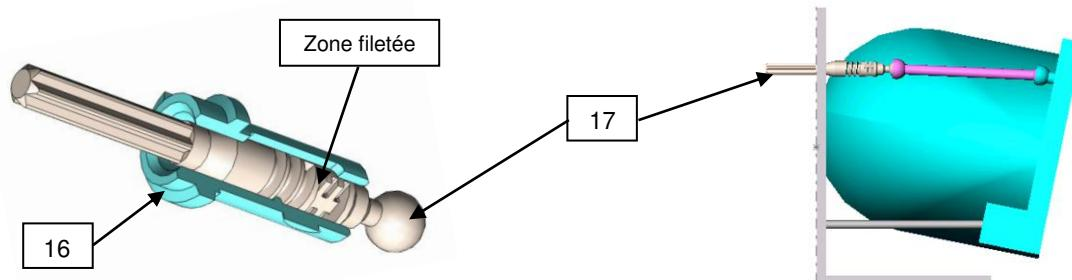
**Réglage motorisé** : le moteur entraîne en rotation la vis **11** qui entraîne l'arbre **15** en rotation. Cet arbre entraîne à son tour la rotation de la roue **13**. Le sous-système vis-écrou (**16-13**) permet de transformer la rotation de la roue **13** en une translation de la tige **17** (liée à **16** en mode motorisé). La sortie de l'ensemble noix-tige (**16+17**) permet l'orientation du phare par l'intermédiaire de la biellette de poussée rattachée à la tige.
